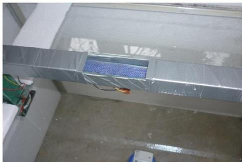
Figura 30b. Sílica gel instalada dentro del ducto de ventilación
