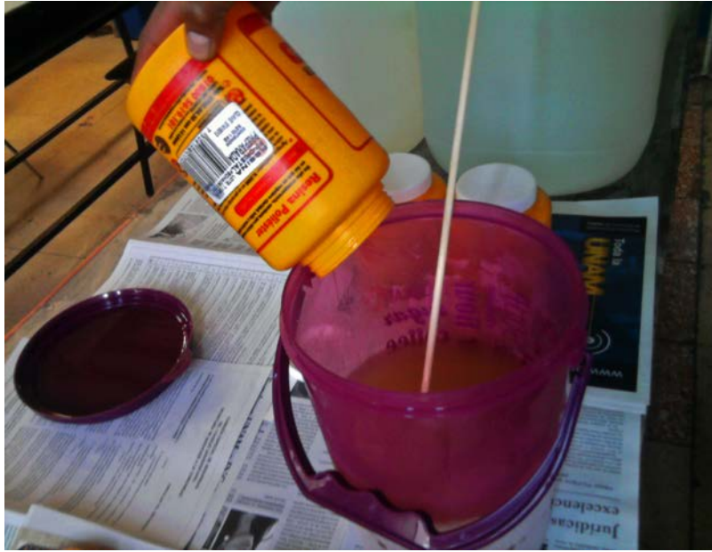
Figura 6. Mezcla de sustancias para los procesos de impregnación de resina.
