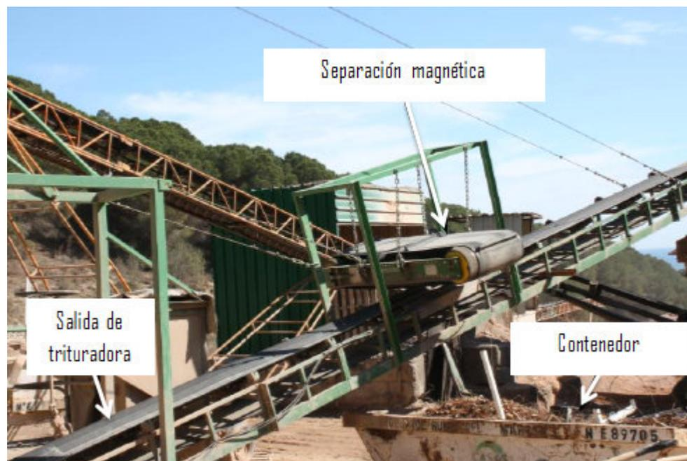
**Figura 19.** Trituración separación magnética secundaria
