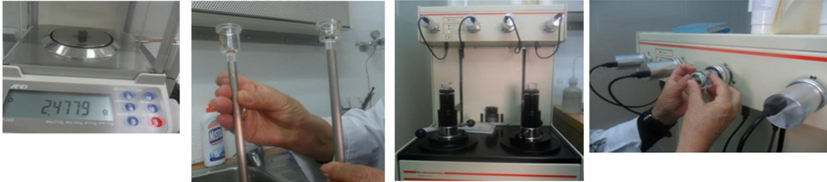
Fig. 82 Ensayo de porosidad (pesado, penetrómetro, porosímetro y prueba a baja y alta presión)
