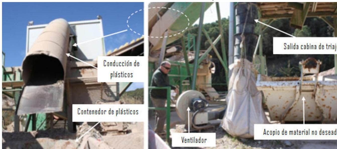
Figura 17. Separación neumática
