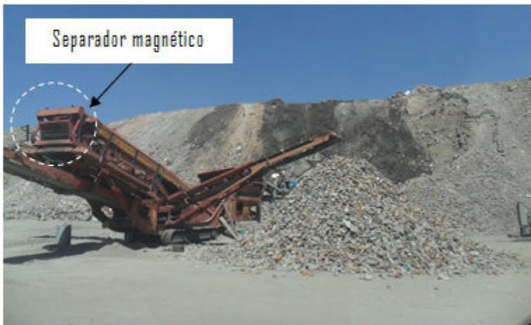
**Figura 61.** Sistema de electroimán con aspersion de agua.
