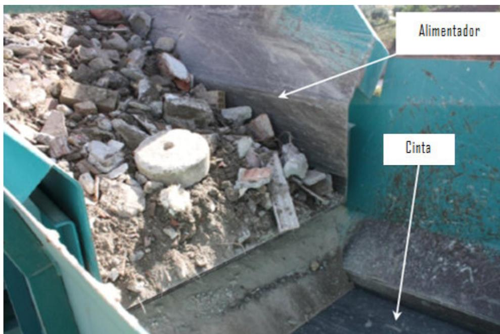
Figura 37. Alimentador vibrante
