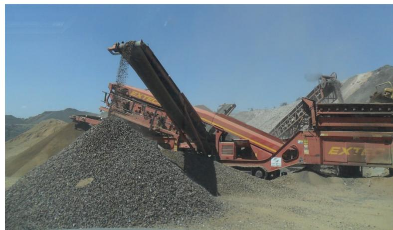
**Fig. 62.** Equipo de cribado con cuatro curvas granulométricas
