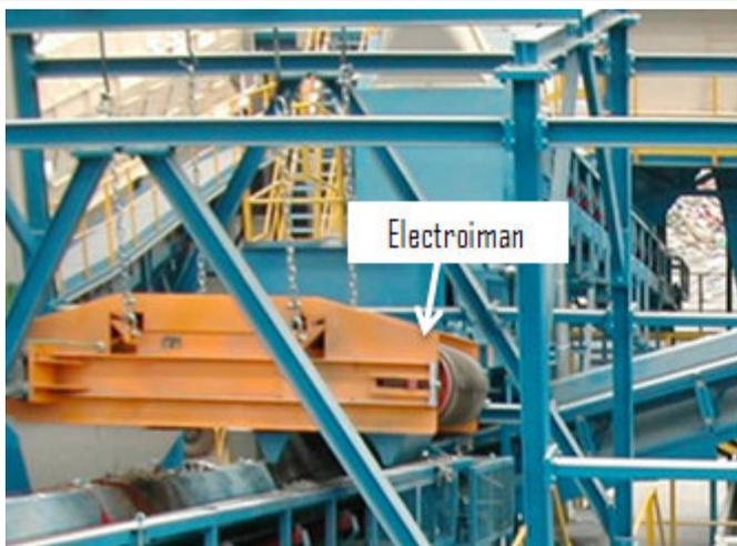
**Figura 52.** Separación magnética. Adaptado de GERD, 2012
