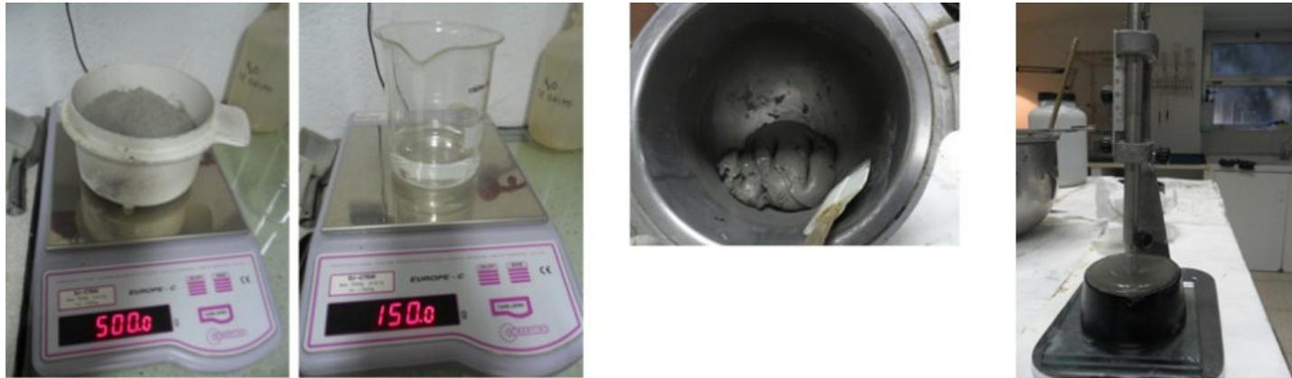
Figura 76. Ensayo de demanda de agua
