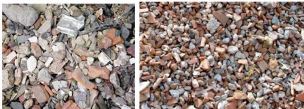
**Figura 65.** Agregado reciclado recolectado en planta
