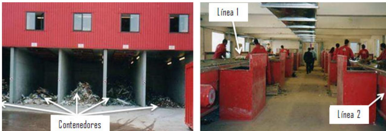
**Figura 54.** Cabina de triaje doble línea de producción. Adaptado de GERD, 2012
