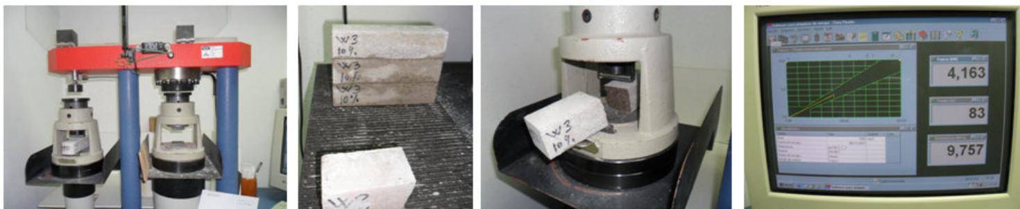
Figura 83. Ensayo mecánico de flexión y compresión para mortero
