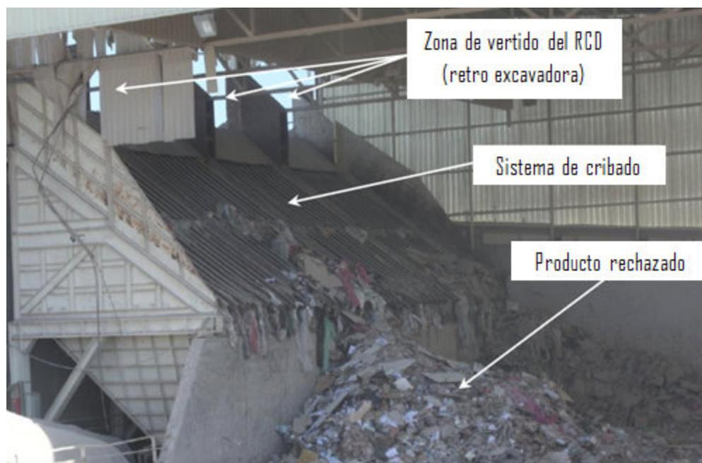
Figura 20. Hangar de acopio del residuo y alimentación sistema
