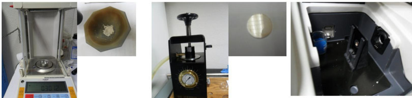
Figura 72b. Ensayo de espectroscopia de infrarrojo
