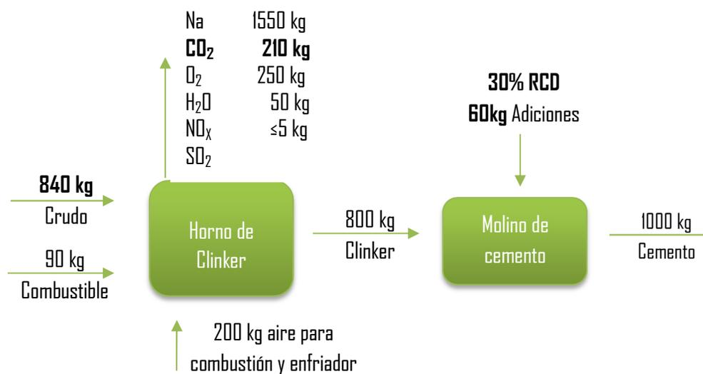
**Figura 91.** Balance de masa para la fabricación de 1t de cemento propuesta utilización de RCD.
