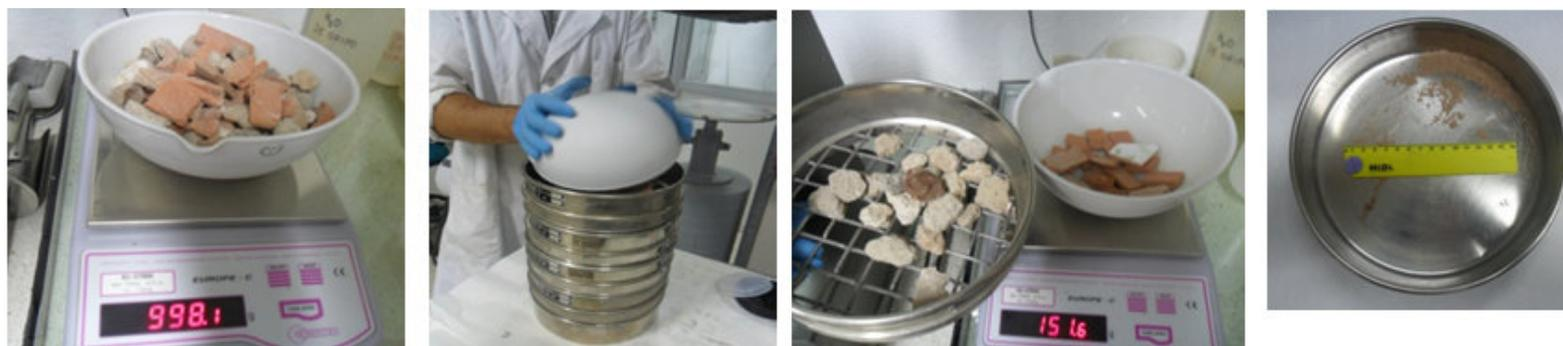
Figura 67 Obtención de curva granulométrica
