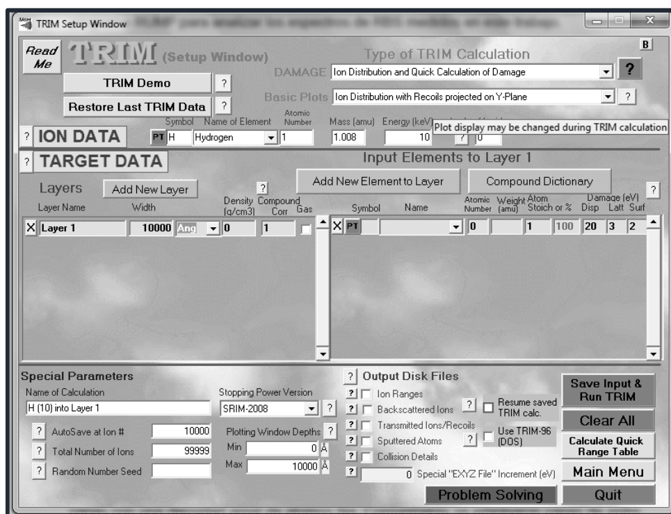
Figura A1.1. Ventana de inicio del programa SRIM (TRIM) en donde se establecen las condiciones para la simulación.
