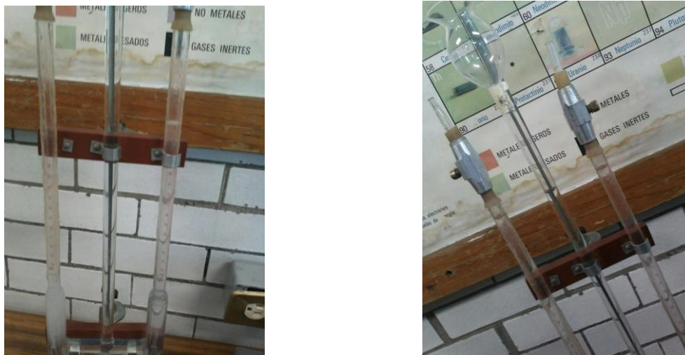
Figura 17. Fotos del Aparato de Hofmann usado en la electrólisis del agua en el CCH.
