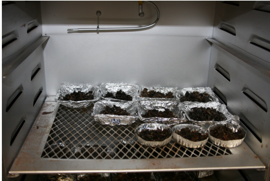
Figura 7. Muestras libres de agua y grasa secándose en estufa a 70°C. Fotografía L. A. Mora Villa
