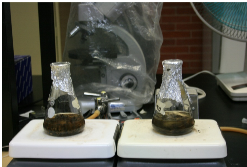
Figura 6. Muestras en matraces con hexano, sometidas a agitación. Fotografía L.A. Mora Villa
