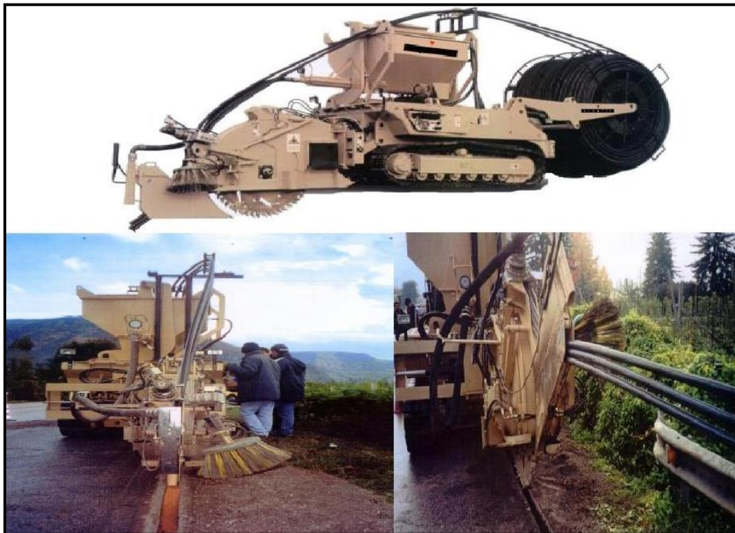
FOTOGRAFÍA 40 “ZANJADORA URBANA (CITY TRENCHER)”
