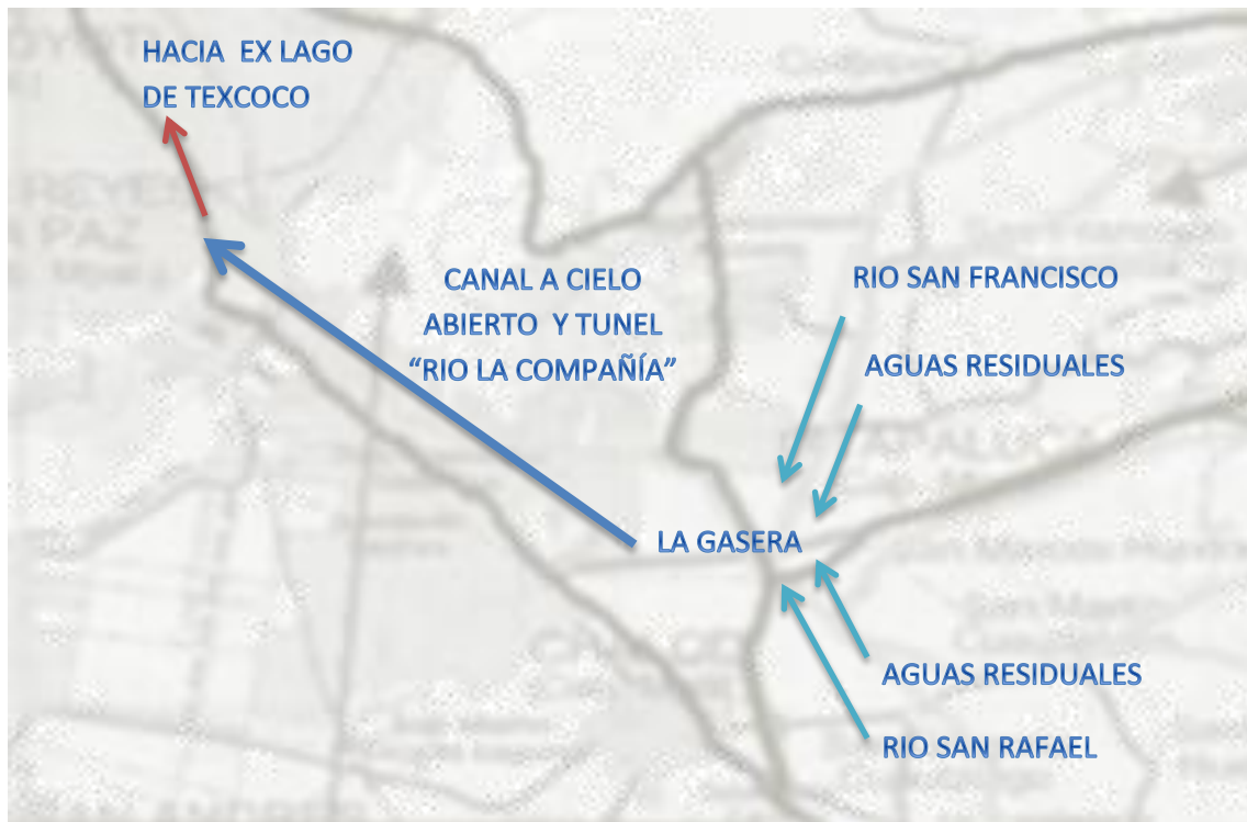
Ilustración 12: Sistema actual de manejo de aguas residuales
