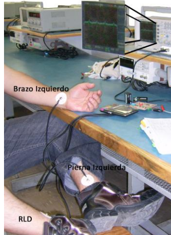
Figura 5.9. Colocación de los electrodos para la Derivación III, brazo izquierdo (LA) y pierna izquierda (LL).
