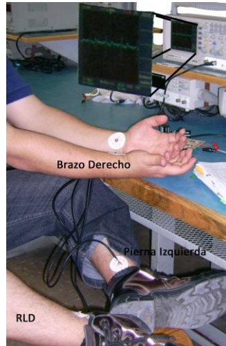
Figura 5.8. Colocación de los electrodos para la Derivación II, brazo derecho (RA) y pierna izquierda (LL).
