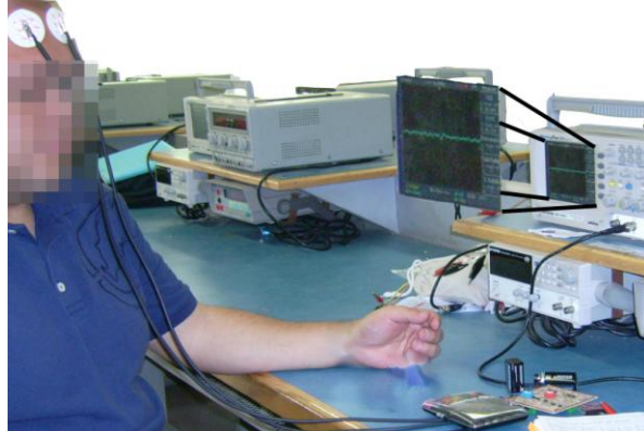
Figura 5.10. Electrodo colocados en montaje transversal para el canal 1, correspondientes a los electrodos FP1 y FP2 (en la frente). 30
