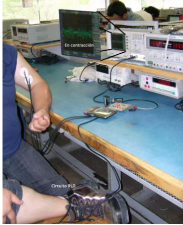
Figura 5.6. Electrodo colocado en el músculo bíceps del brazo izquierdo y Circuito RLD.
