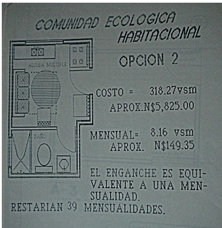
Imagen número 31. Esquema con el que se presentaba un pie de casa para la Comunidad Ecológica habitacional en 1992, en Ciudad Juárez, proveniente de un taller de diseño participativo. Fuente: Leticia Peña.
