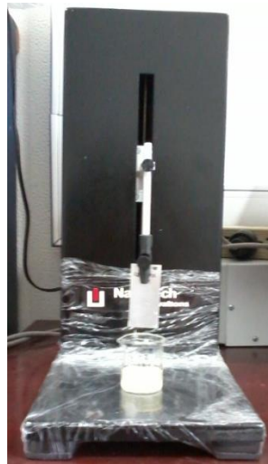
Fig. 2.6 Inmersión de la placa de AA2024-T3, en la solución Sol Gel mediante el dispositivo Dip Coater.
