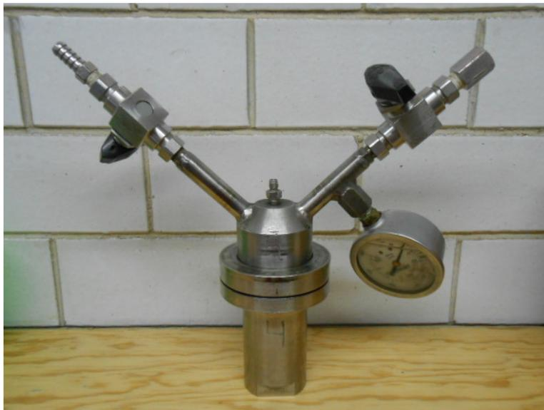
Figura 4.5: Reactor utilizado para la SC-CO<sub>2</sub>-E
