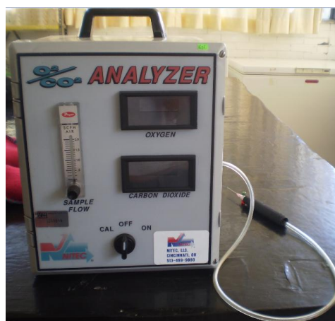
Figura 3. Analizador de gases por infrarrojos (marca NITEC LLC)
