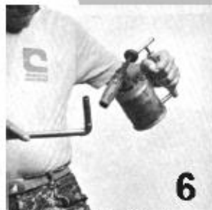
Fig. 2.16. Aplicación de calor
