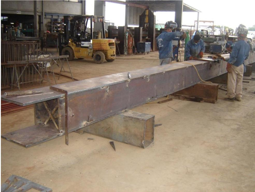
Fotografía 16.- Armado de la columna
