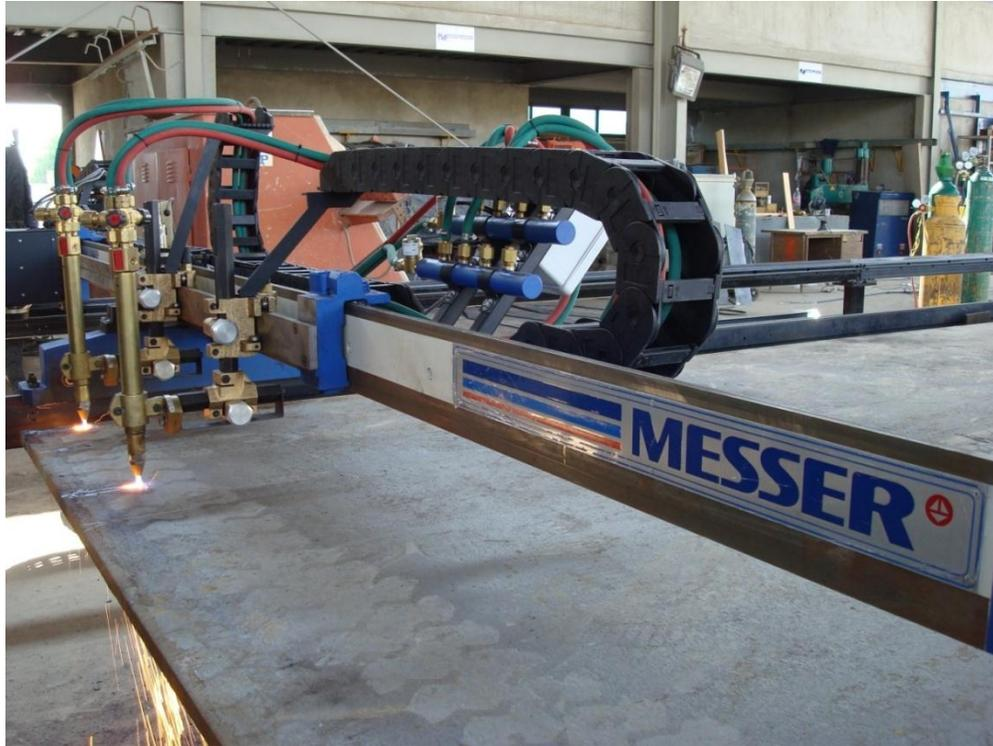
Fotografía 14.- Corte con pantógrafo de la placa.
