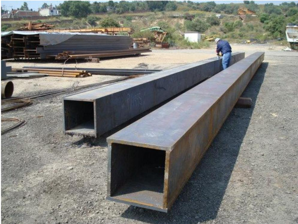
Fotografía 17.- Columnas terminadas listas para embarque a obra.
