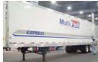
Se utiliza para todo tipo de carga protege contra el medio ambiente, pero no necesita control de temperatura.
