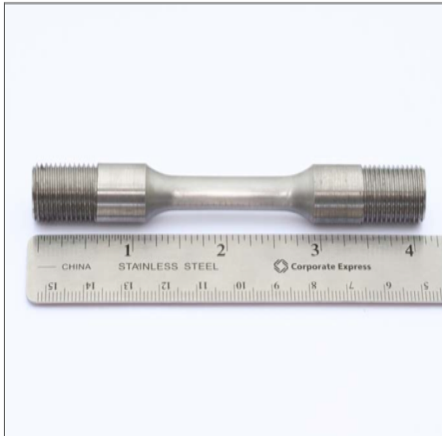
Figura 1 – Espécimen para prueba NECE Método A.
