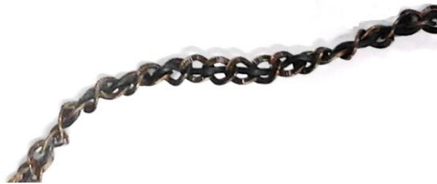
Figura 5.14 Cable trenzado para la conexión de la bocina.
