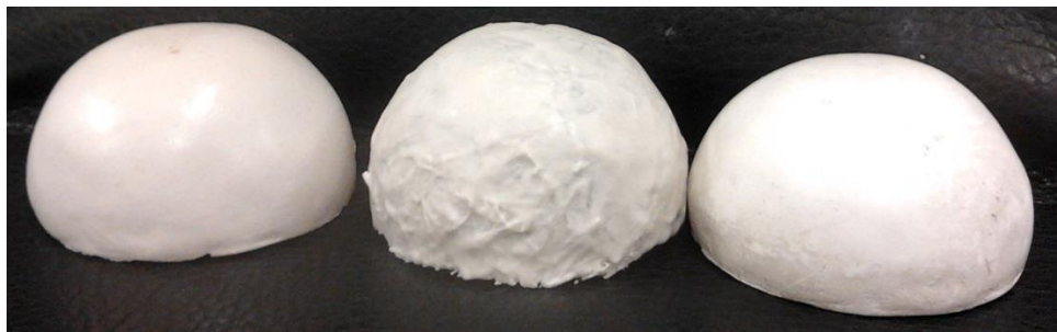
Figura 6.2 Muestras de carcasas para el ensayo de compresión.
