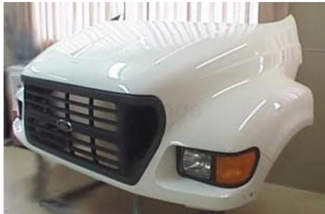
Figura A.3 Frente de camión fabricado con resina poliéster y fibra de vidrio [34].
