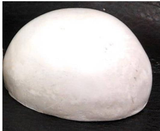
Figura 5.12 Carcasa en fibra de vidrio y resina con recubrimiento de gelcoat .
