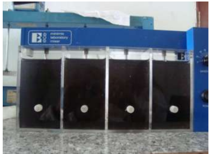
Fotografía 6.- Prueba de coagulación.
