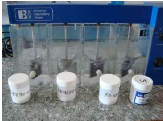
Fotografía 3.- Preparación de polímeros ayudantes de floculación a una concentración de 0.1%.
