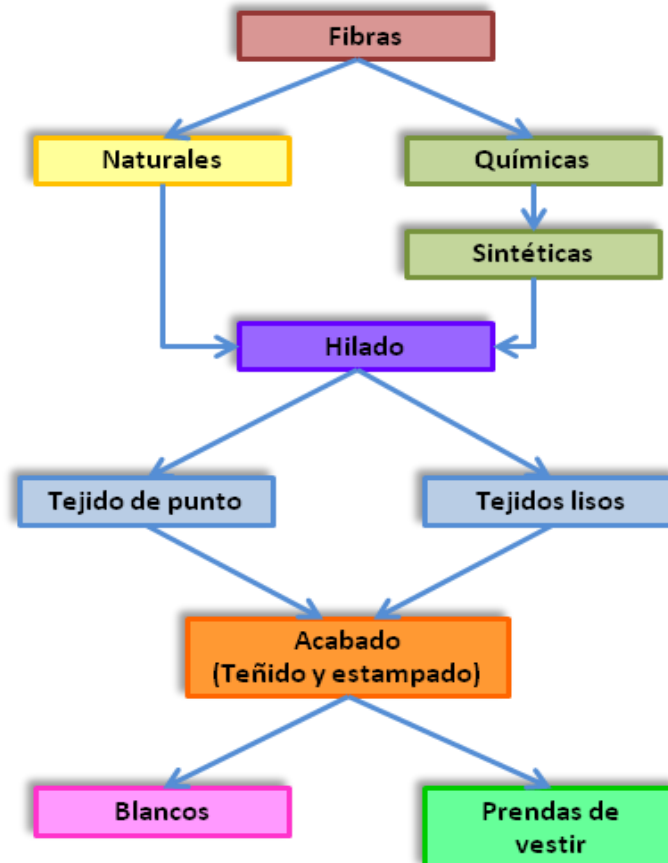
Ilustración 8.- Diagrama de bloques del proceso productivo textil. [7]
