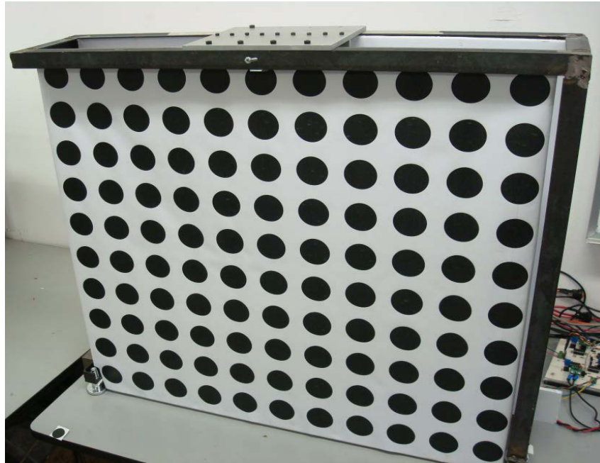
Figura 3.29 Plantilla de calibración sobre el área de trabajo del robot paralelo.
