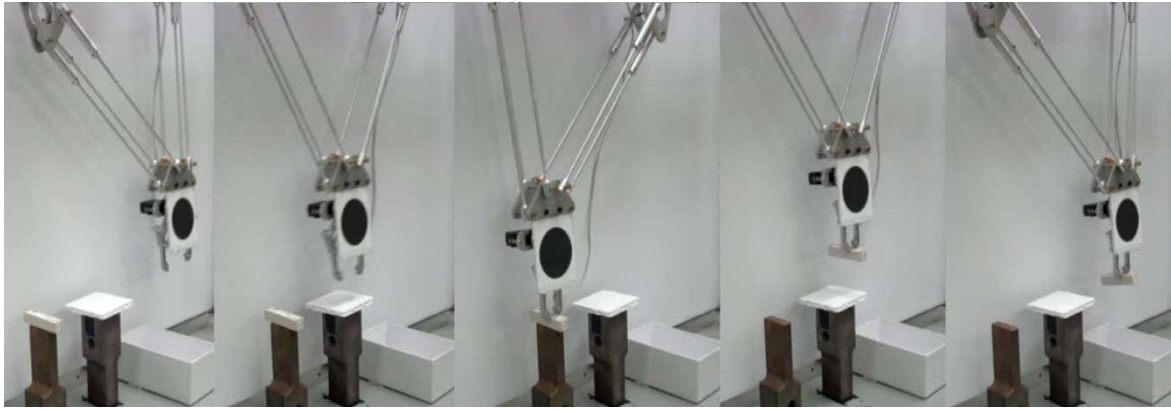
Figura 5.15 Secuencia de trabajo del robot paralelo.
