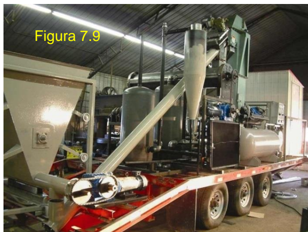
Figura 7.9 Una unidad de pirolisis móvil de tornillos giratorios resguardada en una bodega en Canadá. Esta unidad fue construida por la empresa “Renewable oil International”. Referencia:[197,198,199]
