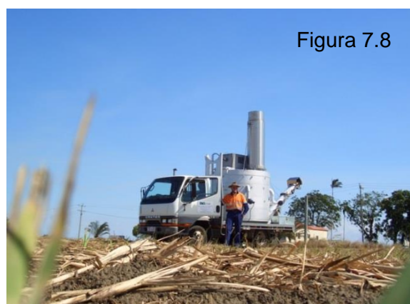
Figura 7.8 Unidad de pirólisis móvil que aprovecha desperdicios agrícolas de una campo de caña de azúcar en Australia.
