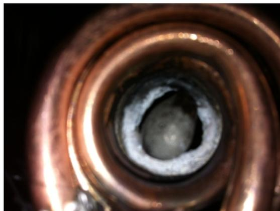
**Figura 6. 6. Montaje experimental para la fundición por inducción utilizando el cerámico nitrurado (en blanco).**
