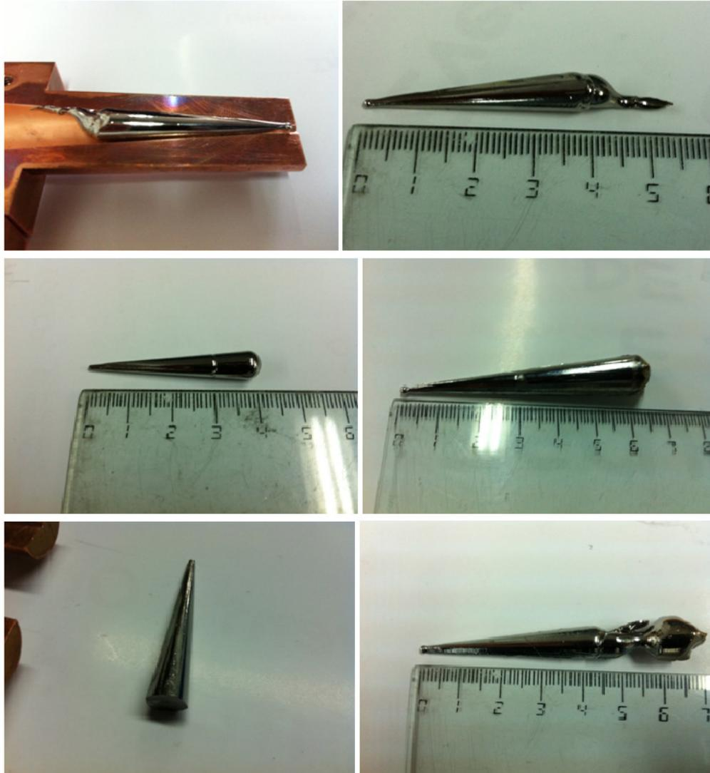
**Figura 6. 7. Lingotes en forma cónica de las 6 aleaciones diseñadas.**
