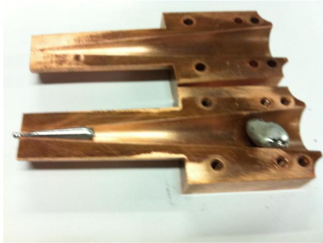
**Figura 6. 5. La figura muestra la separación de la parte más caliente del botón o lingote.**
