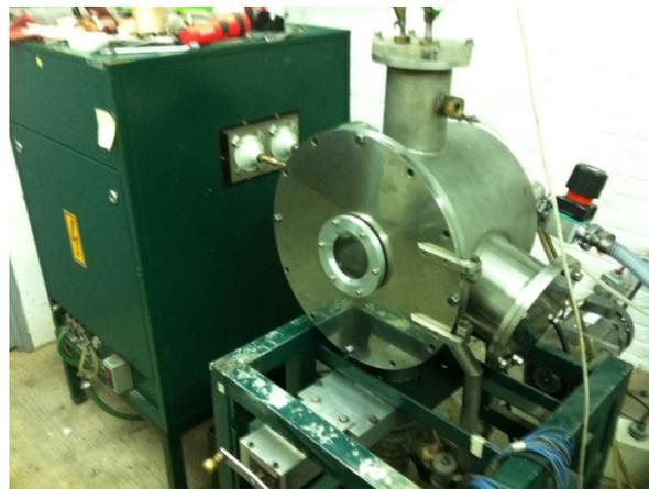
Figura 6. 4. En la imagen pueden observarse los componentes que conforman al horno de inducción, entre ellos se ve el generador, la cámara del horno, la válvula de evacuación, etc.
