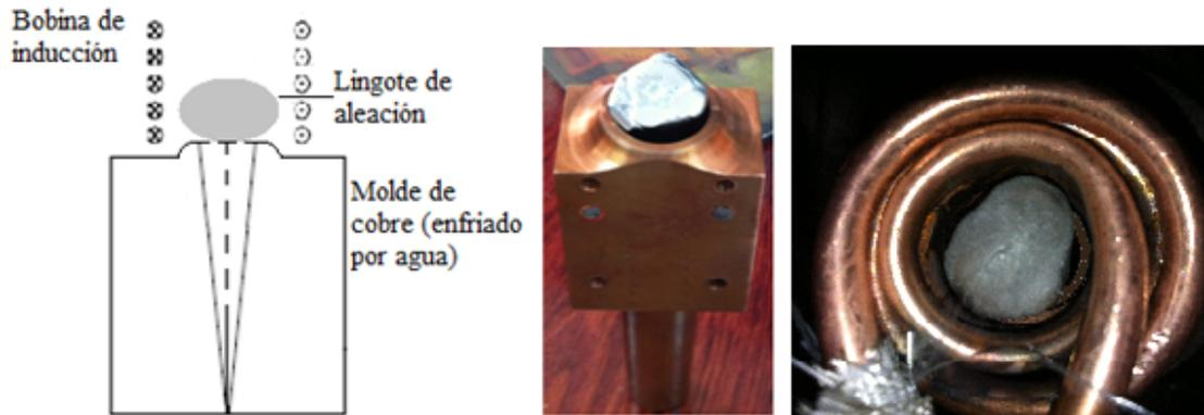
Figura 6. 3. Arreglo experimental para llevar a cabo el drop-casting o colada por gravedad.
