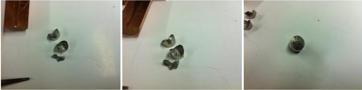
**Figura 6. 8. El lingote aparentaba estar bien conformado, sin embargo, al manipularse se fue desmoronando.**
