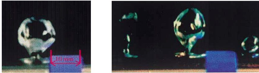
a) b) Figura 2.13. Formación de burbujas al inyectar gas de amoníaco en la solución amoníaco-agua con una concentración del cero por ciento. a) formación. b) desprendimiento
