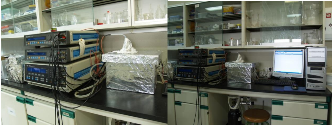
Figura 17. Conexión de la celda electroquímica con el Potenciostato y la computadora.
