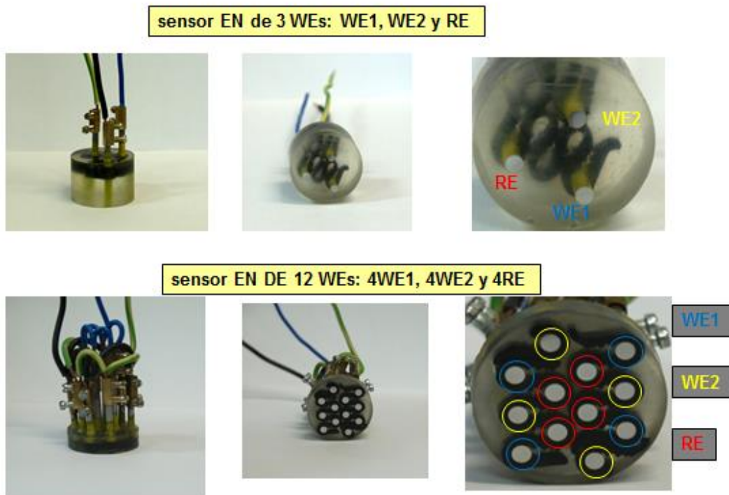
Figura 19. Arreglo de conexión en los sensores
