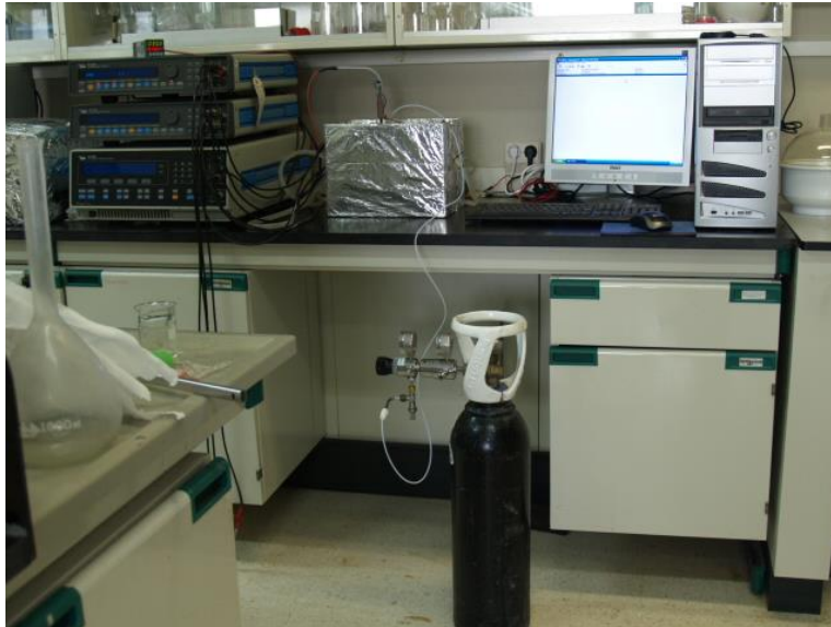
Figura 14. Dispositivo para la eliminación de oxígeno con nitrógeno.
