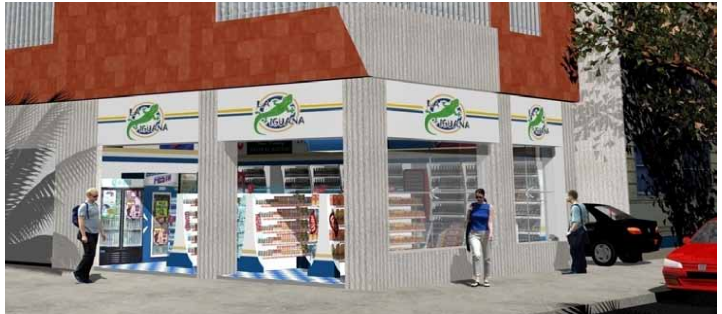
Propuesta 05. Imagen virtual del proyecto ubi- cado en Calle San Borja. Aquí ve- mos otra solución al tema de los toldos exteriores, debido a que era requerimiento del proyecto se propusieron solo cajas lumi- nosas que no sobresalían de la edi- ficación.
