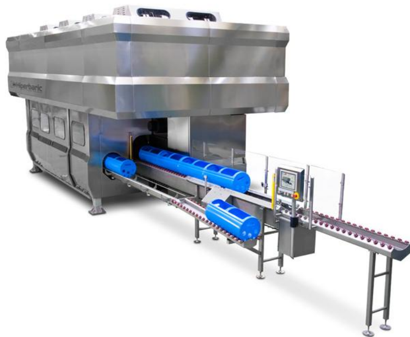
Figura 13. Equipo de API a escala industrial ( Hiperbaric, sin año )
