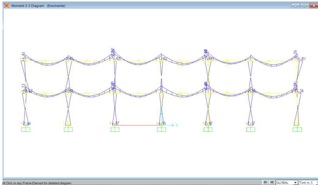
Figura 6.1.2 Diagramas de momento flexionante por combinación Envolverte
