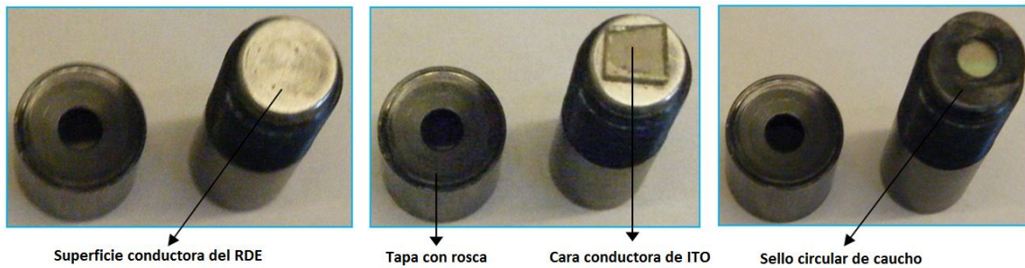
Fig. 24. Procedimiento para acoplar los electrodos de ITO a la cabeza de un RDE
