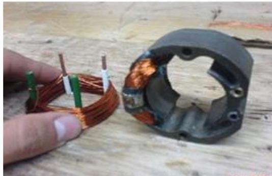
Figura 3.11 Estator del motor universal.
