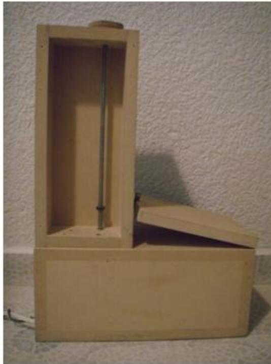
Figura 2.2 Tornillo sinfín montado en el dispositivo.
