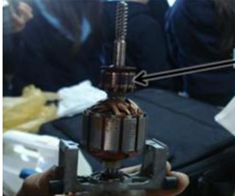
Figura 3.14 Colector del motor universal.
