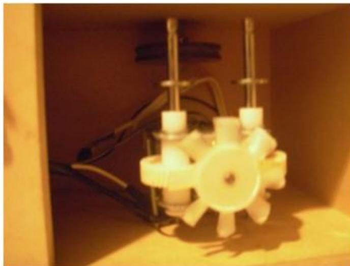
Figura 2.3 Motor acoplado mediante una banda al tornillo sinfín.
