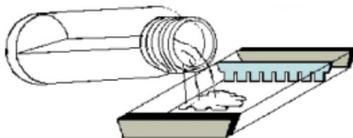
4. Esperar a que polimerice y colocar en la cámara con la solución amortiguadora de corrida. Llenar el tanque de la cámara por encima de un cm de gel.
