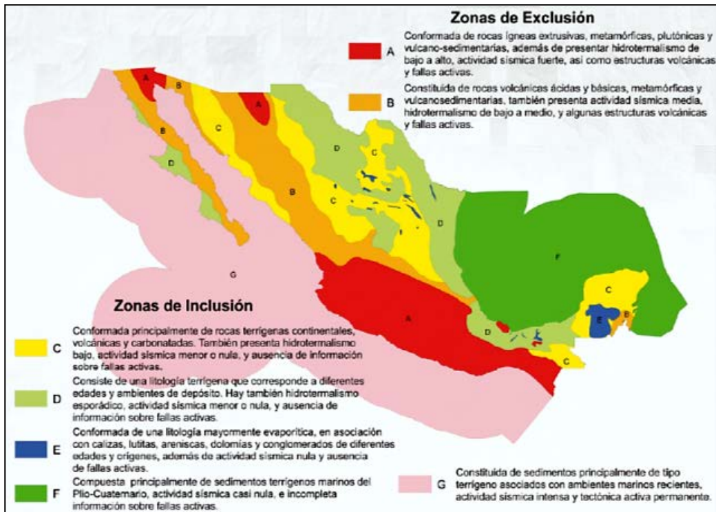
FIG. 23 Zonas de inclusión y exclusión para almacenamiento geológico de CO 2 en México (Dávila, 2010).
