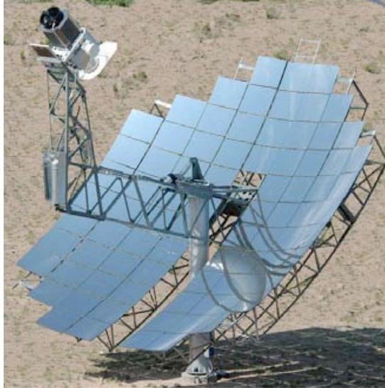
**Figura 4.13 Concentrador de disco con motor Stirling y generador eléctrico integrado**
