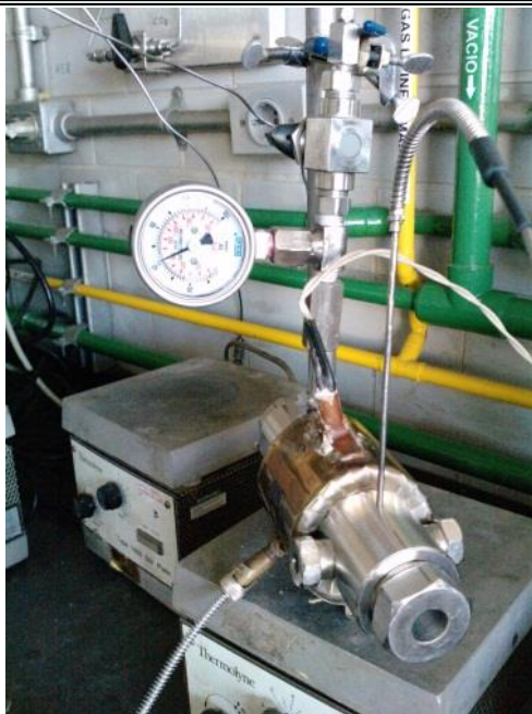
Figura 4. 2. Celda de alta presión con mirillas.
