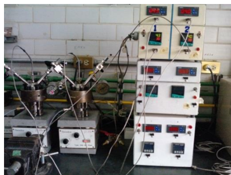
Figura 4. 1. Bomba para fluidos comprimidos y reactores de alta presión.
