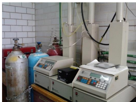
Figura 4. 1. Bomba para fluidos comprimidos y reactores de alta presión.
