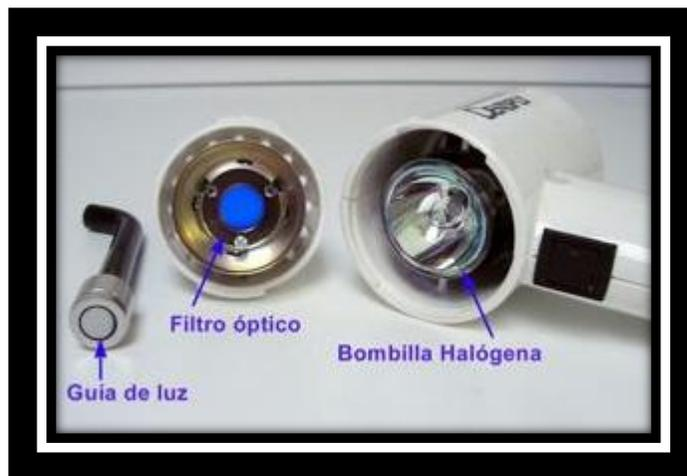
Fig.3 Bombilla halógena y filtro óptico para luz azul.
