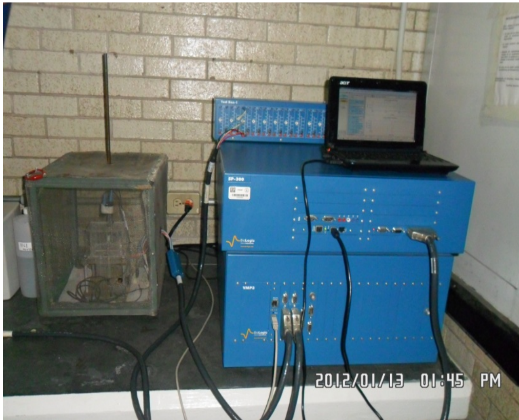
Figura 3.5. Dispositivo empleado para los distintos ensayos electroquímicos.
