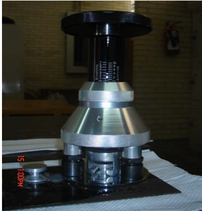
Figura 3.3. Equipo para ensayos de adherencia Elcometer 106 (método de tracción).
