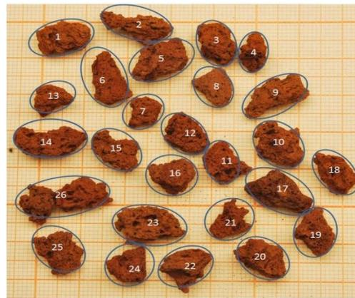
**Figura 5.5** Forma geométrica del tezontle con diámetro promedio de 9.5 mm.
