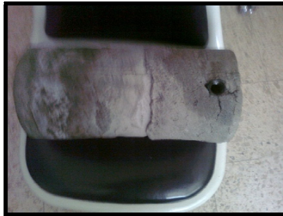
Figura 4.3 termo tanque aislado térmicamente con una mezcla de ceniza
