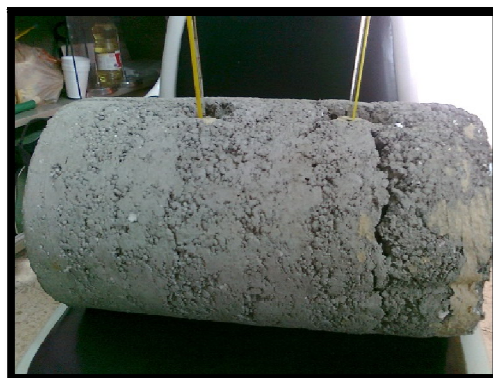
Figura 4.6 termo tanque aislado térmicamente con una mezcla de ceniza y unisel
