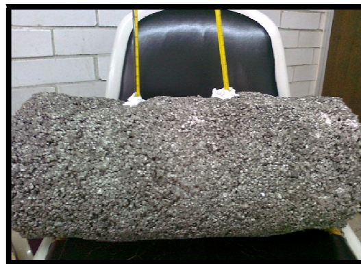
Figura 4.9 termo tanque aislado térmicamente con una mezcla de ceniza (en menor proporción) y unicel
