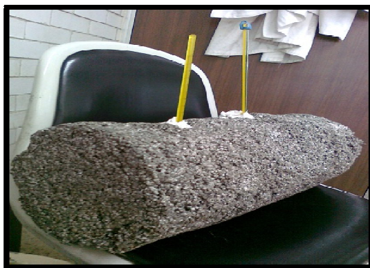
Figura 4.10 termo tanque aislado térmicamente con una mezcla de ceniza (en menor proporción) y unicel
