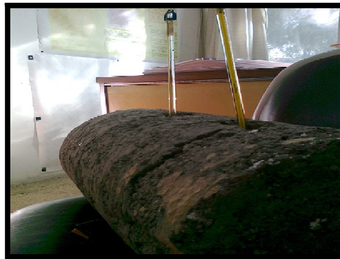
Figura 4.6 termo tanque aislado térmicamente con una mezcla de ceniza y unisel
