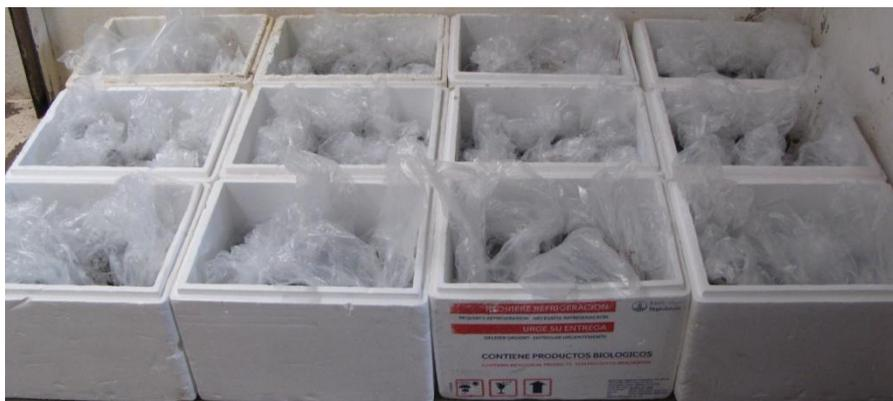
**Figura 9.** Alojamiento de los reactores anaerobios dentro de las cajas de unicel
