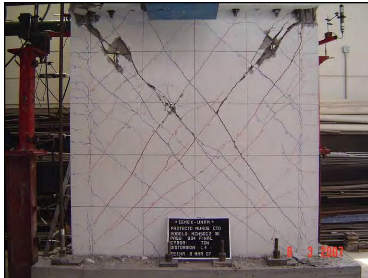
Figura S.33 Estado final de daño del muro MCN50C2
