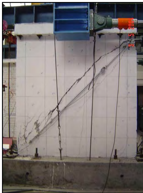
Figura S.9 Estado final de daño del muro MCN100M
