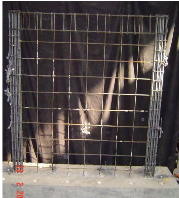
Figura L.7 c) Armados de los muros con 100% de la cuantía mínima establecida en NTC-C (MCN100M, MCC100M, MCA100M)
