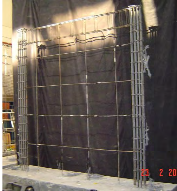
Figura L.7 b) Armado de los muros con 50% de la cuantía mínima establecida en NTC-C (MCN50M, MCC50M, MCA50M)
