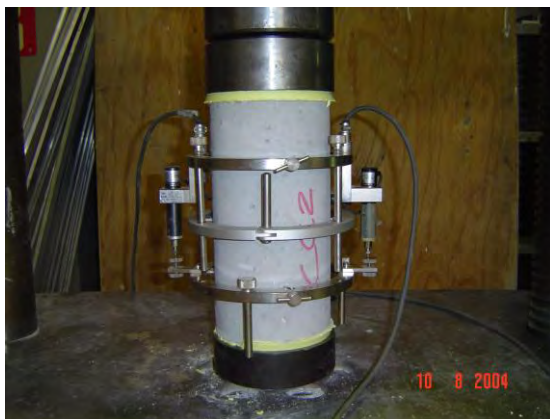
Figura N.1 Dispositivo de ensaye de los cilindros de concreto
