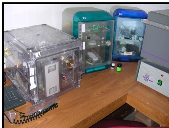
Figura A.4.7. Desecadores con exceso de sustancias químicas, algunas sin etiquetar.
