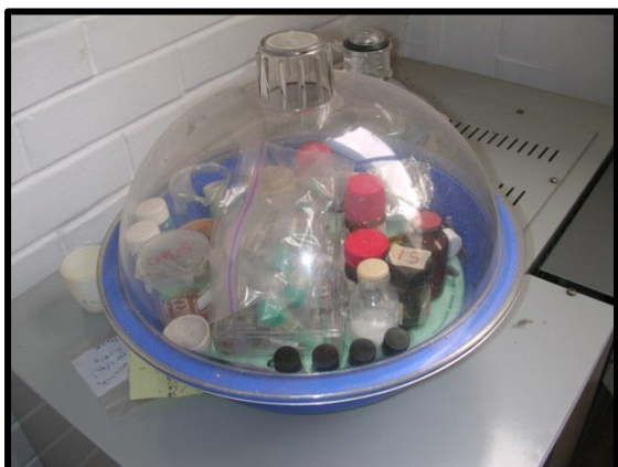
Figura A.4.7. Desecadores con exceso de sustancias químicas, algunas sin etiquetar.
