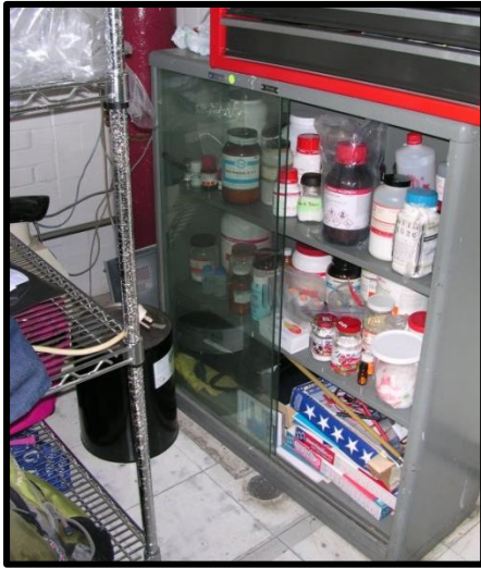
Figura A.4.9. Sustancias químicas sin clasificar almacenadas junto a material de papelería.
