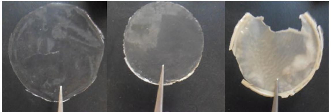
**Fig. 16** Membranas a) Nafion 117, b) PE-S 18 y c) Híbrida de PE-S 18% de sulfonación y 10% de silanos
