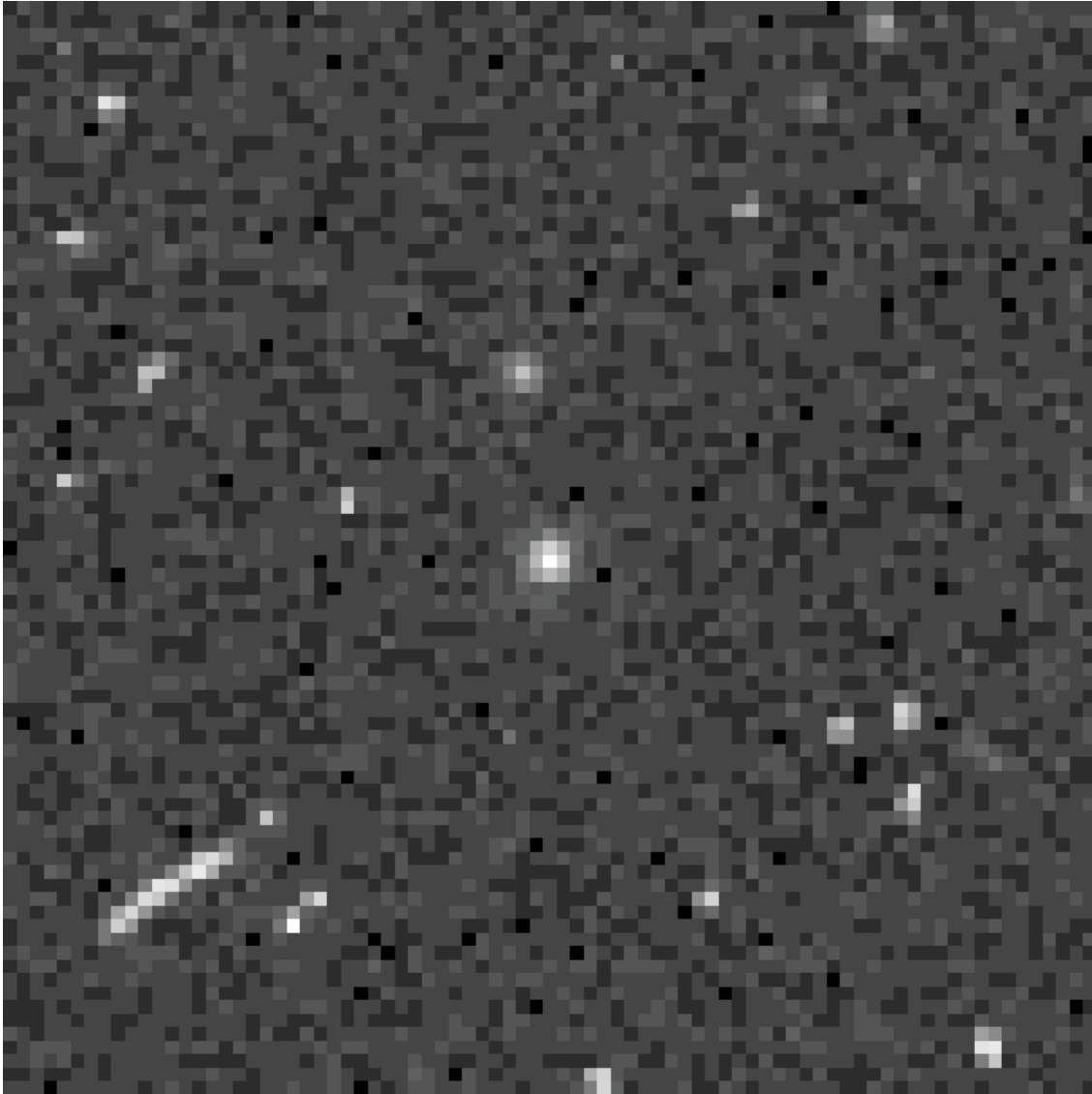
Figura 3.9: Comparación entre una imagen estelar y varios rayos cósmicos. Se observa claramente una estrella en el centro de la imagen, y un rayo cósmico rasante.
