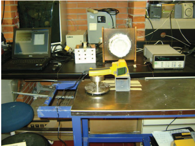
Figura 5.11. Medida indirecta de la emitancia de la muestra con un pirómetro.
