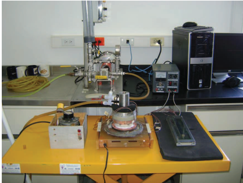
Figura 5.10 Instrumentación de las muestras de alúmina-sílice.
