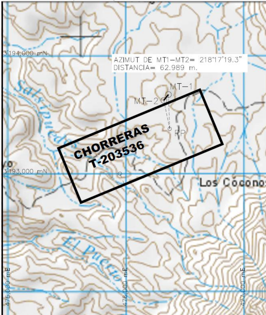
Lote minero CHORRERAS T-203536 mostrando su PP y sus dos mojoneras testigo MT.
