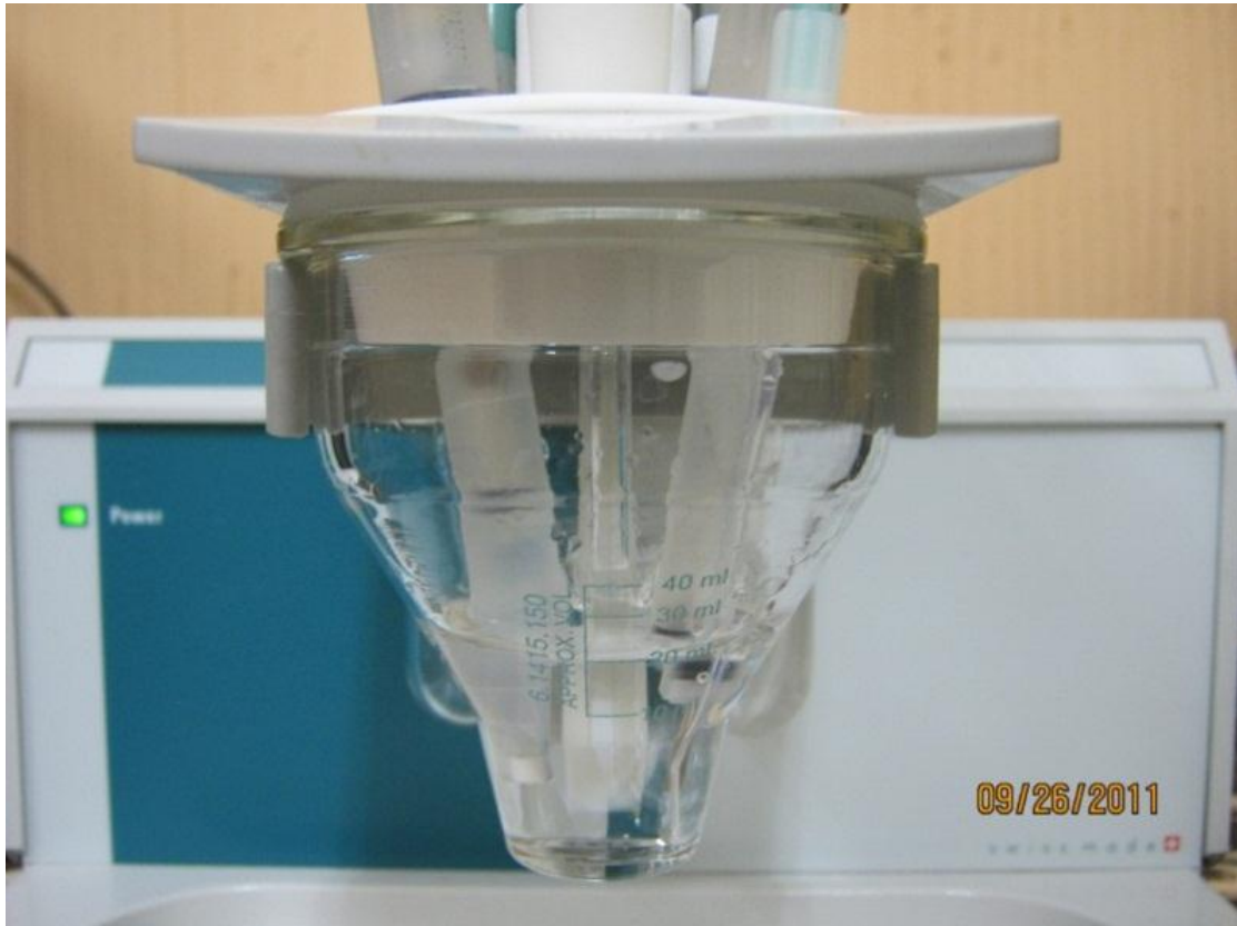
Figura 2.7 Celda con tres electrodos. Electrodo de trabajo de mercurio, electrodo de referencia de Ag/AgCl y electrodo auxiliar de platino.
