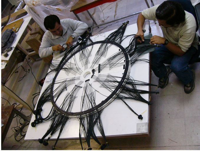
Figura 2.8: En la fotografía se muestra el detector casi terminado, con el forro de Nylamid, las fibras dentro del centellador y los acopladores para los PMTs sosteniendo un extremo de las fibras.
