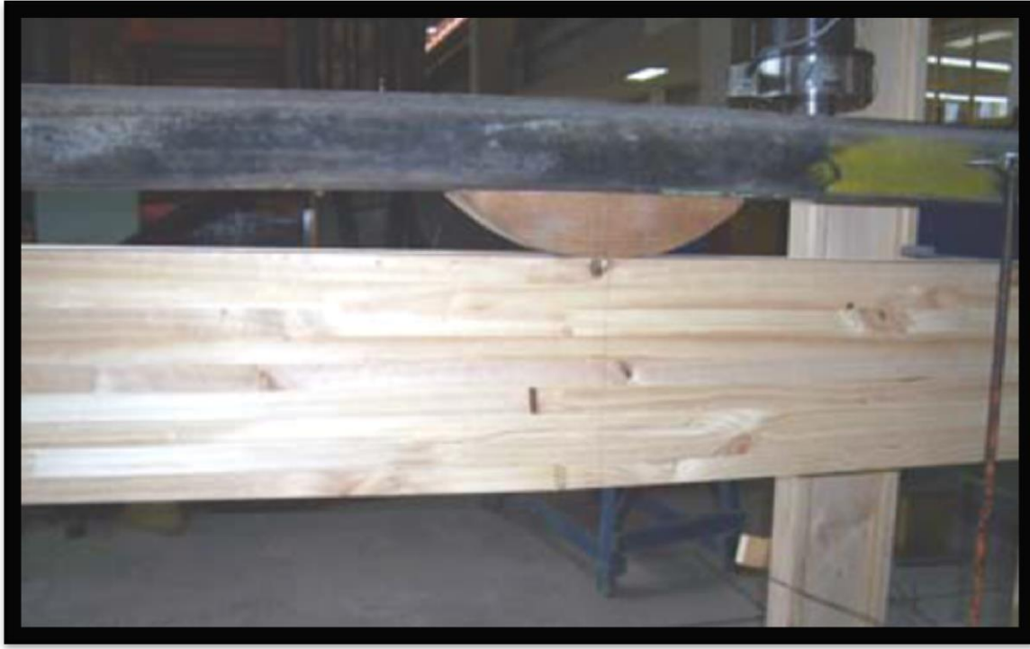
Fig. 3.5 En esta figura se muestra una pieza donde la falla se origina por deslizamiento entre laminaciones de madera, propiciando que se agotara la capacidad de carga e iniciara el descenso de la carga.
