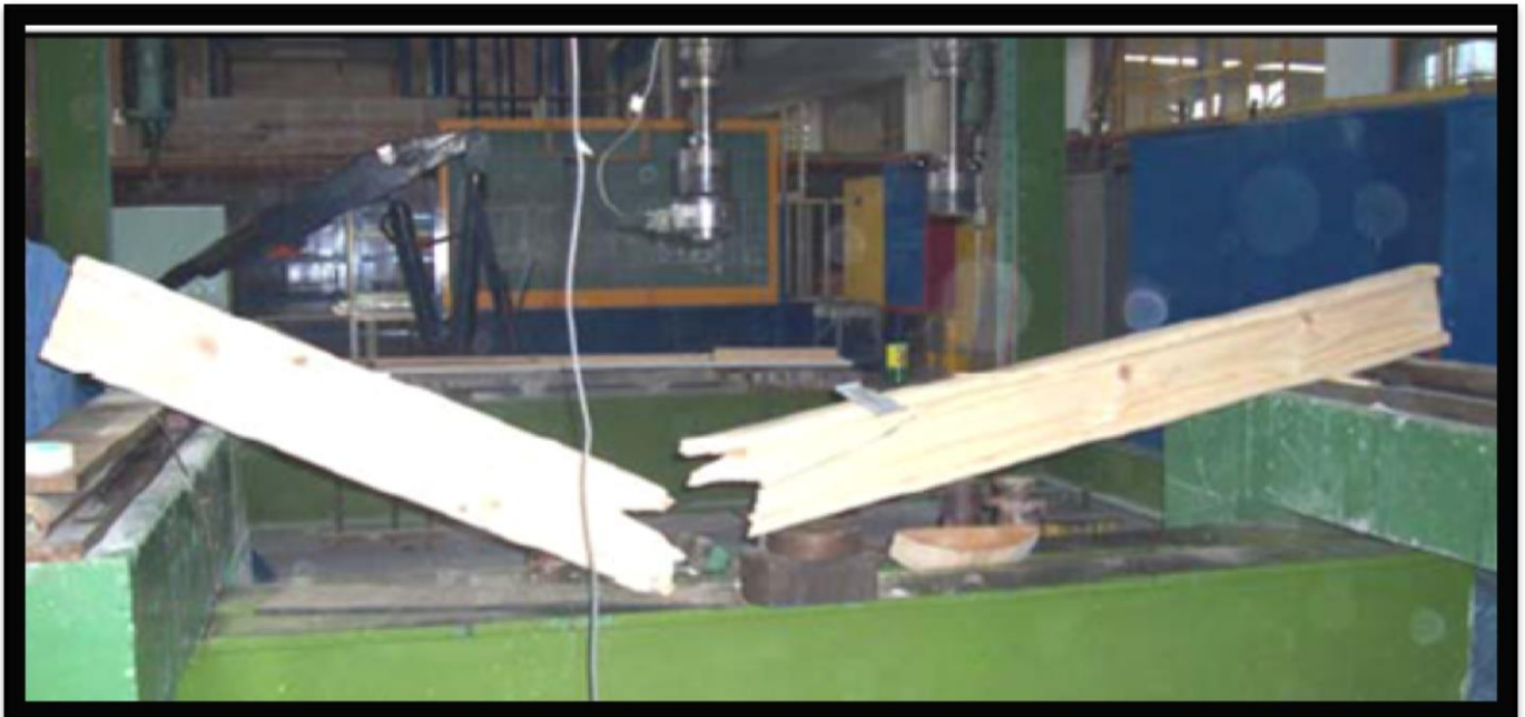
Fig. 3.7 En la figura se muestra la falla en la segunda viga I, como es posible observar, ocurre por tensión en la zona de momento flexionante puro, siendo esta la falla más aparatosa que se registró. Sin embargo por el contrario de la anterior su resistencia fue del orden del 50%.
