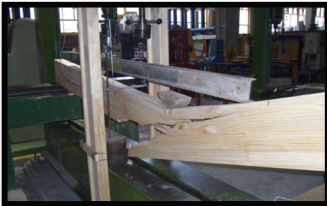
Fig. 3.4 El colapso de la viga mostrada inicio en la zona de momento flexionante máximo, propagándose instantáneamente en forma inclinada en dirección del claro de cortante.
