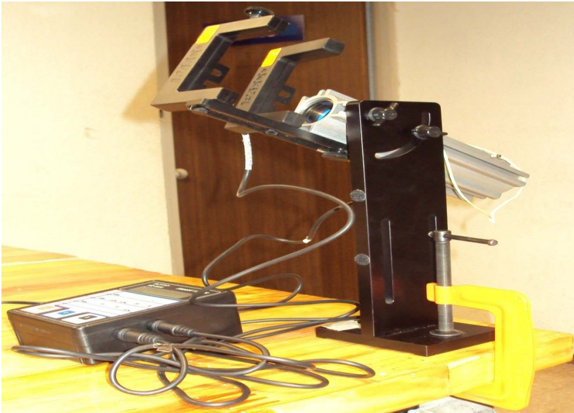
Figura III.5.2 Configuración del experimento de tiro parabólico en el laboratorio
