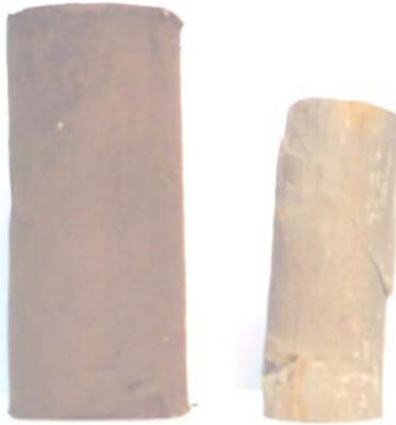
Figura II.19.- Contracción por secado de probetas de arcilla (Martín D., 2011).
