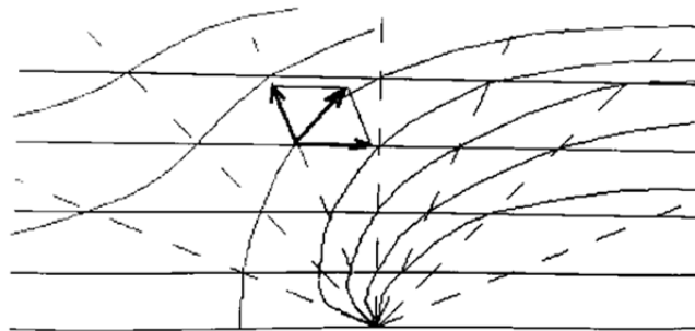
Figura II.40.- Superposición gráfica de la red de flujo de un escurrimiento uniforme y una fuente (Fernández, 1999).
