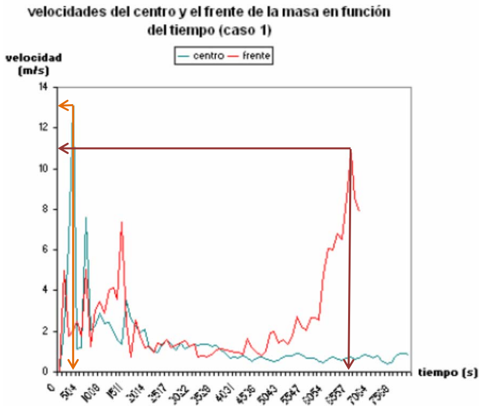
Figura VI.15.- Evolución de la altura y velocidad del material deslizante en función del tiempo CASO 1 (SPH, 2001).
