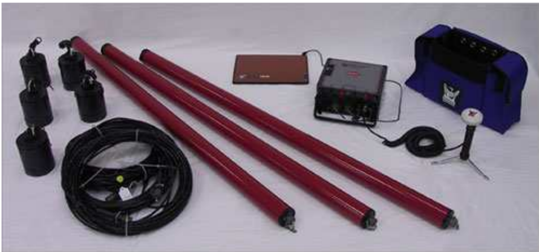
Figura 4.2 – Dispositivos que conforman el Sistema V5 2000 (phoenix-geophysics.com, 2009).
